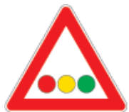
F.R 190 031 B semaforo con lanterne orizzontali
